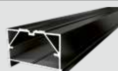
BIG-Isostep (Alu) 54 Terrassenlager Abstand Auflagepunkte max. 110 cm
