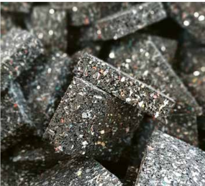
Isopads aus 95 % Altreifengranulat
